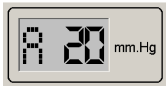
Рисунок 3 – Индикация усредненного значения измерений
